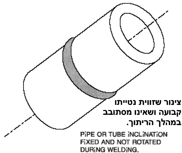
6G – ריבוי תנוחות לריתוך בדיקה – 6G (D) MULTIPLE WELDING TEST POSITION—6G
