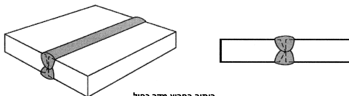
ריתוך בחריץ מדר כפול (B) DOUBLE-BEVEL-GROOVE WELD
