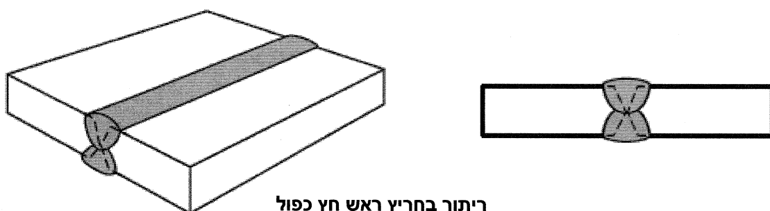
ריתוך בחריץ מדר כפול (B) DOUBLE-BEVEL-GROOVE WELD
