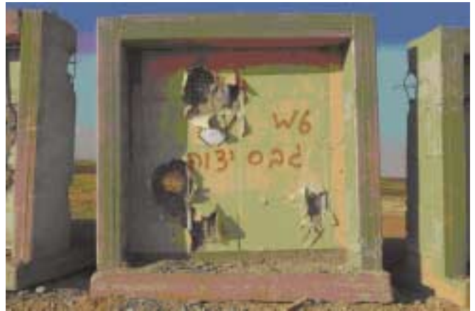
תמונה מס' 16 - חיפוי גבס המיושם קודם היציקה בהשפעת רסס
