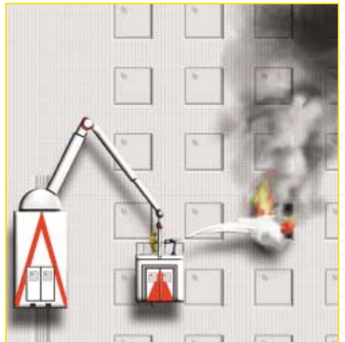
ציור 2 - מערכת (Automatic Rescue Climber) ARC
